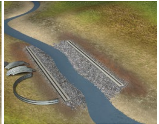
La première section de l'arche est entièrement assemblée au sol.
