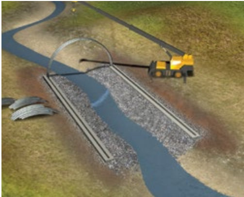
La section est ensuite soulevée, mise en place et boulonnée aux semelles de chaque côté.
