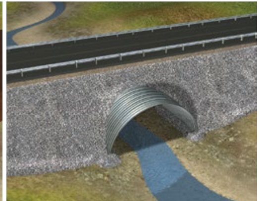
La chaussée est ensuite complétée, ce qui comprend les glissières de sécurité.
