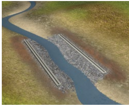
Des semelles en béton préfabriquées ou coulé sur place sont posées sur le terrain préparé.
