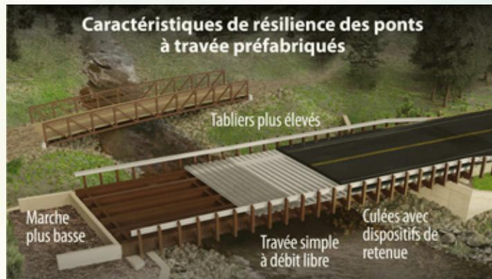
**Résistance aux changements climatiques :** caractéristiques de résilience aux conditions météo extrêmes aptes à réduire les risques d'inondation et de dommages causés par des débris en raison des changements climatiques – p. ex., travée plus large, remblai renforcé par géotextile, protection anti-affouillement, dégagement vertical accru et plus encore.
