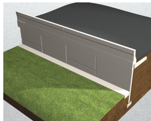
On termine par le couronnement, les glissières de sécurité et la surface de roulement.
