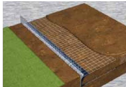
Ajout du remblai de pierres choisies en façade.
