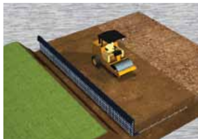
Treillis de soutien, toile, drainage, première levée.
