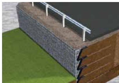
Ajout du remblai, de la glissière et du revêtement.
